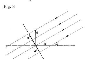
Die Verkürzungsverhältnisse in senkrechter und waagrechter Richtung sind vom gewählten Projektionswinkel  $\omega$  abhängig. Es sind nach Fig. 8 b' = b · sin  $\omega$  und h' = h · cos  $\omega$  ( $\omega$  = Winkel zwischen den Projektionsstrahlen und der Horizont- oder Grundrissebene).
