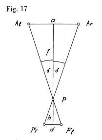
Da man mit dem Apparat nicht h, sondern h' — die schräg projizierte Äquidistanz, vergl. Fig. 8 — einstellt, so ist wegen h' =  $h \cdot \cos \omega$  noch eine Korrektur vorzunehmen. Man müsste also bei steiler Betrachtung die stereoskopische Verschiebung verstärken, d. h. den Winkel  $\delta$  grösser wählen. Weil man aber die Bilder meist überhöht zeichnet, genügen die am Zeichentisch einstellbaren Winkel für eine starke plastische Wirkung.
