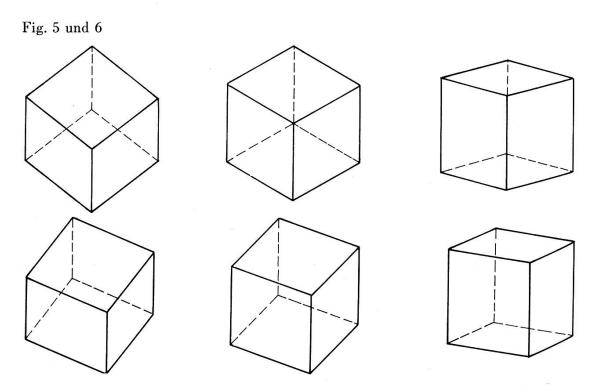
In Fig. 5 sind die Projektionen eines Würfels unter drei verschiedenen Winkeln (50°, 35° 16′, 15°) dargestellt, wobei die oberen und unteren Flächendiagonalen senkrecht, bzw. parallel zur Drehachse verlaufen. Fig. 6 zeigt die Projektionen unter den gleichen Winkeln, jedoch mit abgedrehten Flächendiagonalen.
