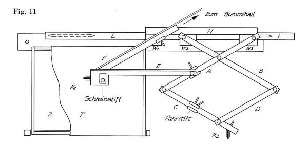
Die übertragbare Fläche der Karte misst parallel zur Grundschiene 40 cm, senkrecht dazu 36 cm (beim Projektionswinkel 60°) bis 60 cm (Projektionswinkel 9°). Da der Apparat parallelperspektivische Bilder liefert, können diese beliebig zusammengesetzt werden, sofern immer die gleiche Blickrichtung eingehalten wird.
