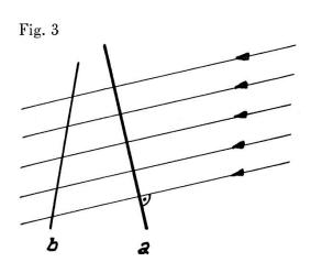
Stehen die Projektionsstrahlen senkrecht auf der Zeichenebene (Fall a in Fig. 3), so spricht man von normaler Parallelperspektive oder Axonometrie, stehen sie schief, so liegt schiefe Axonometrie vor (Fall b in Fig. 3). Der PERSPEKTOMAT P-40 liefert Bilder in normaler Axonometrie.
