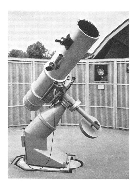
Spiegel-Teleskop der Schul- und Volkssternwarte Schaffhausen. Knick-Säule. Fernrohr in Wiege drehbar. Elektrische Nachführung und Kupplung. Parabolspiegel von 26 cm Durchmesser, Brennweite 181 cm, Öffnungsverhältnis ca. 1:6,9. Heute vierfacher Okularrevolver.
