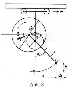
In sinngemässer Uebertragung der Konstruktion der Amslerschen Integratoren kann dafür ein Linearplanimeter verwendet werden, welches zwei, sich aussen verzahnende Zahnräder trägt. Das kleinere vom Durchmesser d wird vom Fahrarm um den Betrag a von der y-Richtung aus mitgenommen. Das grössere, mit dem Durchmesser 2d, trägt die Integrierrolle, und wird um den Winkel  $\frac{\alpha}{2}$  gegen die y-Richtung gedreht \*) (Abb. 2).
