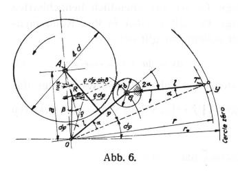
Die Abb. 6 stellt ein derartiges Radial - Quadratwurzelplanimeter für von aussen nach innen steigende Kreisdiagramme dar. Mit einem im Diagrammzentrum 0 drehbaren gleichschenkeligen Kniehebel, dessen freies äusseres Ende den Fahrstift F trägt, wird die zu
