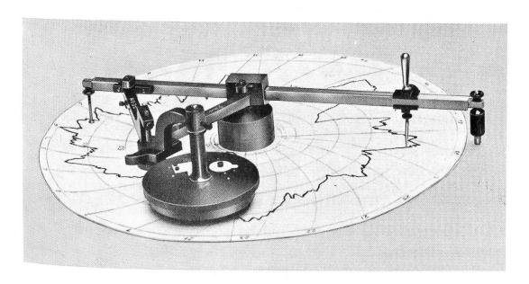
Abb. 10 Radialquadratwurzelplanimeter Diagramm mit Nullkreis innen
