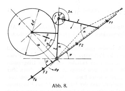
Die Grenzen des Ausmasses der mit einem Instrument auswertbaren Diagramme sind durch die dem Instrument zugrunde gelegte Kniehebel-Armlänge bestimmt.
