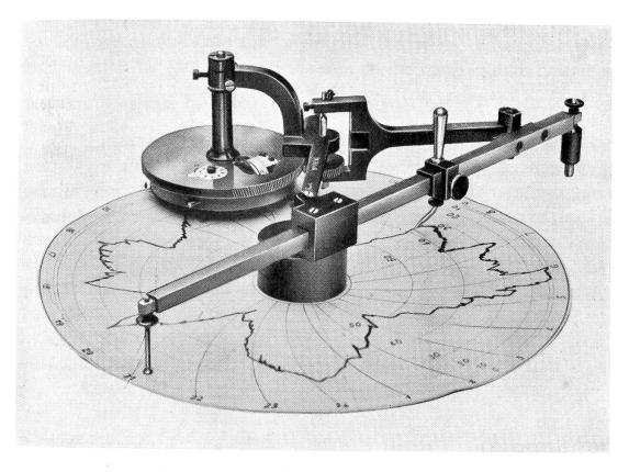
Abb. 9 Radialquadratwurzelplanimeter Diagramm mit Nullkreis außen
