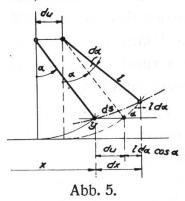
Wird nämlich (Abb. 5) während der Zurücklegung eines kurzen Bogens ds der Flächenkontur durch den Fahrstift die Lagenänderung des Fahrarms von der Lage  $(x, \alpha)$  zur unendlich benachbarten Lage  $(x+dx, \alpha+d\alpha)$  in ihre Komponenten zerlegt, so gilt offenbar
