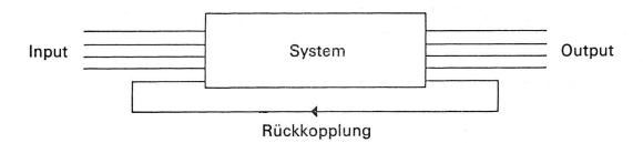
Diese Rückkopplung ist in der Kybernetik von fundamentaler Bedeutung. Sie gestattet erst eigentlich die Regelung und Steuerung von Vorgängen. Einer der ältesten Regler im technischen Bereich ist der Fliehkraftregler bei der Dampfmaschine von Watt:
