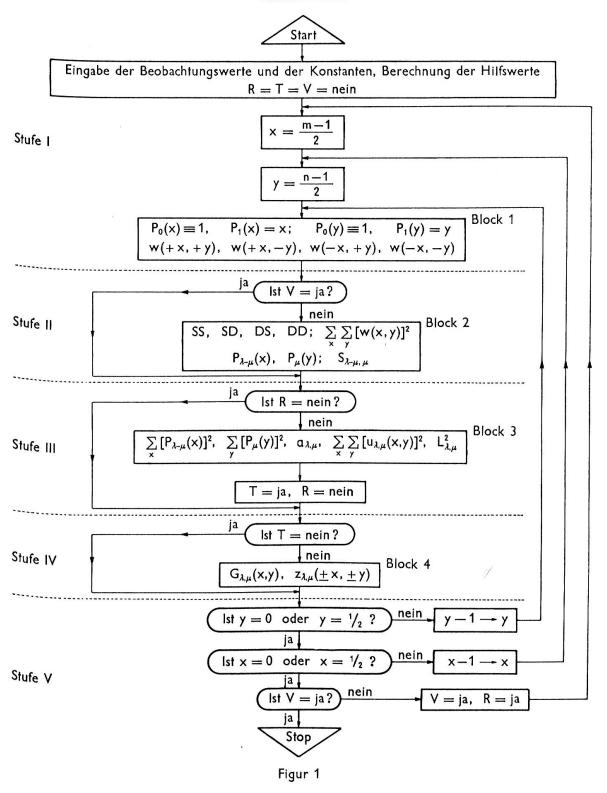
Jede der vier ersten Stufen dieses Ablaufdiagramms besteht aus mehreren Abschnitten. Ohne auf die letzten Einzelheiten einzugehen, sei beispielsweise Programmblock 4 der Stufe IV aufgegriffen.
