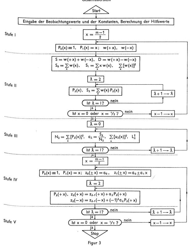
Ende des Programmes nur einmal niedergeschrieben und durch eine «zyklische» Organisation entsprechend oft angerufen. Beim ohnehin einfacheren eindimensionalen Ausgleichsverfahren haben wir dagegen die wenigen Befehle zweimal geschrieben (vgl. Figur 3, Beginn und Ende der Stufen I/II und IV/V). Die Stufen II, III und IV sind jetzt ganz unabhängig voneinander, und die Programmstruktur tritt klarer hervor.
