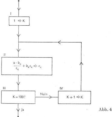
Ein solches Schema, genannt Flussdiagramm, ist noch kein Programm und hat zunächst auch nichts mit Rechenautomaten zu tun, sondern ist vorerst nur als Mittel zur Darstellung des Rechenablaufs zu verstehen. Es enthält alle Angaben über die durchzuführende Berechnung in übersichtlicher Weise und wird daher die Aufstellung des Rechenprogramms stark erleichtern und Programmierungsfehler vermeiden helfen.
