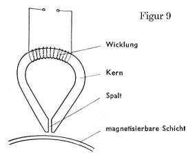
dünnen magnetisierbaren Schicht auf der Oberfläche einer rotierenden Trommel statt. Die Aufzeichnungen erfolgen auf zahlreichen nebeneinanderliegenden Spuren durch kleine Elektromagneten, sogenannte Magnetköpfe, die in grosser Zahl über die Trommeloberfläche angeordnet sind. Meistens üben die Magnetmagnetisierbare Schicht köpfe nicht nur Aufzeichnungs-, sondern auch Wiedergabefunktionen aus. (Fig. 9).
