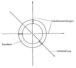
Stromstösse sind gerade so stark, dass sie zusammen ausreichen z<sup>ur</sup> Magnetisierung des Kerns. Für jeden Impuls muss ein Kern vorhanden sein, der zum Speichern eines Wertes L oder O dient.
