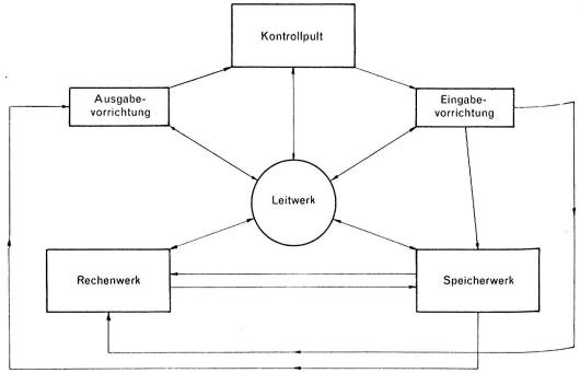
Das Speicherwerk ist ein Gerät, das imstande ist, Zahlen, Buchstaben und Befehle in sogenannten Speicherzellen aufzubewahren, um sie im Bedarfsfalle zur weiteren Verwendung wieder zur Verfügung zu stellen. Es liefert dem Rechenwerk für jede Operation die Ausgangswerte und nimmt die Ergebnisse auf. Auf die verschiedenen Arten von Speicherungsmöglichkeiten werden wir noch zurückkommen.
