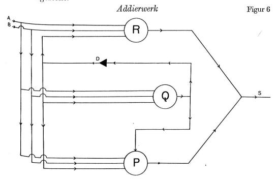
Die Funktionsweise dieses Addierwerkes ist aus folgendem Schema ersichtlich, in welchem die Vorgänge dargestellt sind, wie sie bei der Addition der i-ten Dualstelle zweier Zahlen auftreten, die bei A bzw. B angelangt sind. Bei A und B kann also je ein Impuls vorhanden sein oder nicht. Bei D ist dann ein Impuls vorhanden, wenn bei der Addition der vorangehenden Dualstellen ein Übertrag stattgefunden hat, andernfalls nicht.
