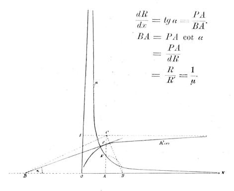
Zieht man im Abstand 1 parallel zur Abszissenachse eine Parallele, verlängert das Perpendikel in A nach C und konstruiert das rechtwinklige Dreieck BCD, so wird
