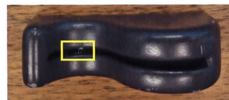
Dispositivo di skimming con lettore della banda magnetica.
