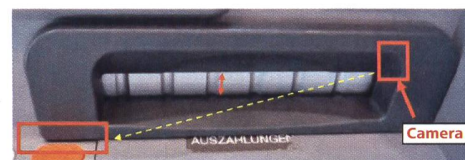
1 Dispositivo di skimming con mini camera e chiavetta USB.
