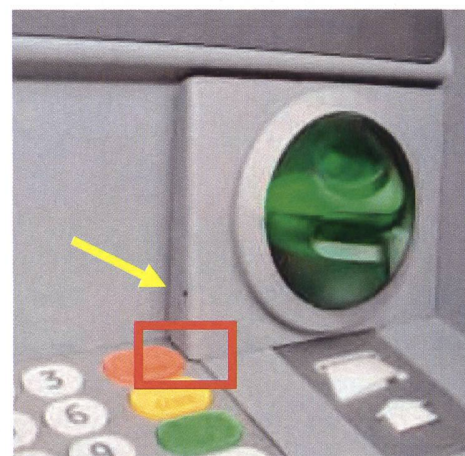
3 Mini camera installata per la registrazione dei codici NIP.
