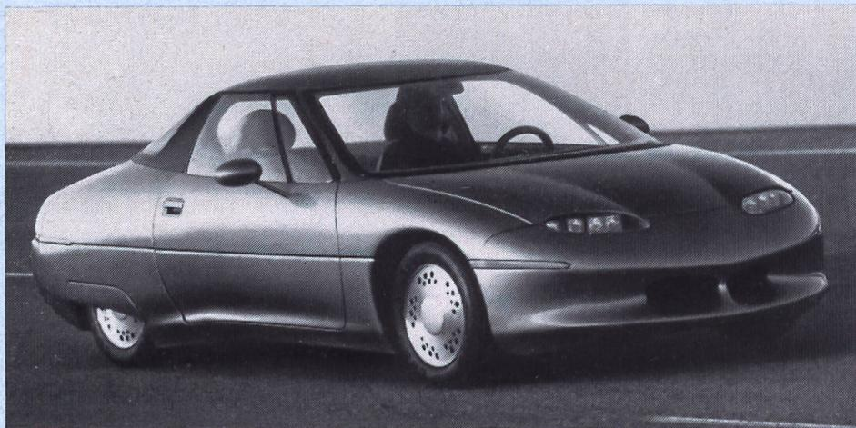
*L'autovettura con trazione a batteria CM Impact, in grado di percorrere quasi 200 km alla velocità costante di 90 km orari.*
