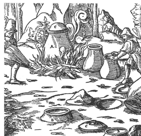
Sommaria raffinazione del petrolio grezzo nel XVI secolo a scopo medicinale. Scaldato in grandi vasi di rame o ferro, veniva liberato dagli elementi leggeri.
