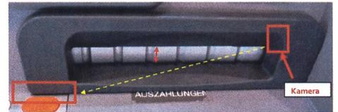
1 Dispositif de skimming avec mini camera et clé USB.
