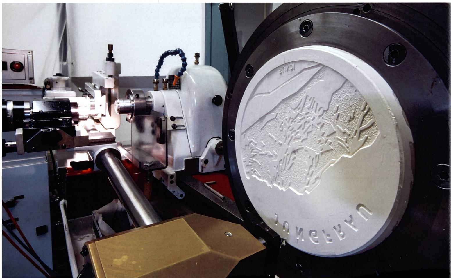
**Un modèle surdimensionné sert de base à la fabrication du coin de frappe.**
