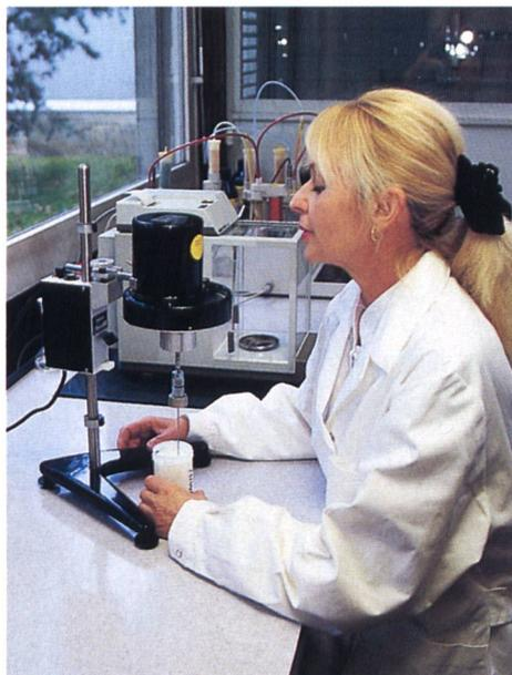
Une des étapes du contrôle qualité, le viscosimètre.
