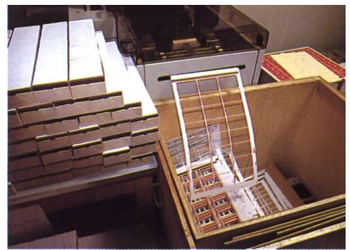
**Les quatre couches disposées sur une plaque de cuivre passent dans la lamineuse et sortiront de presse, transformées en cartes Telecom.**
