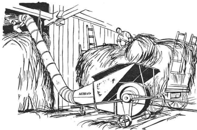
Selon le travail prévu, nous livrons des souffleurs-engrangeurs mobiles et des installations fixes avec des tuyaux de 500 mm et 600 mm de diamètre. Le rendement horaire varie, suivant la force disponible, entre 4000 kg et 6000 kg de foin. Nous garantissons un bon fonctionnement non seulement avec le foin, mais également avec les gerbes de lieuse et à main, la paille bottelée, le foin haché, etc. L'installation travaille sans l'habituel grondement si désagréable.
