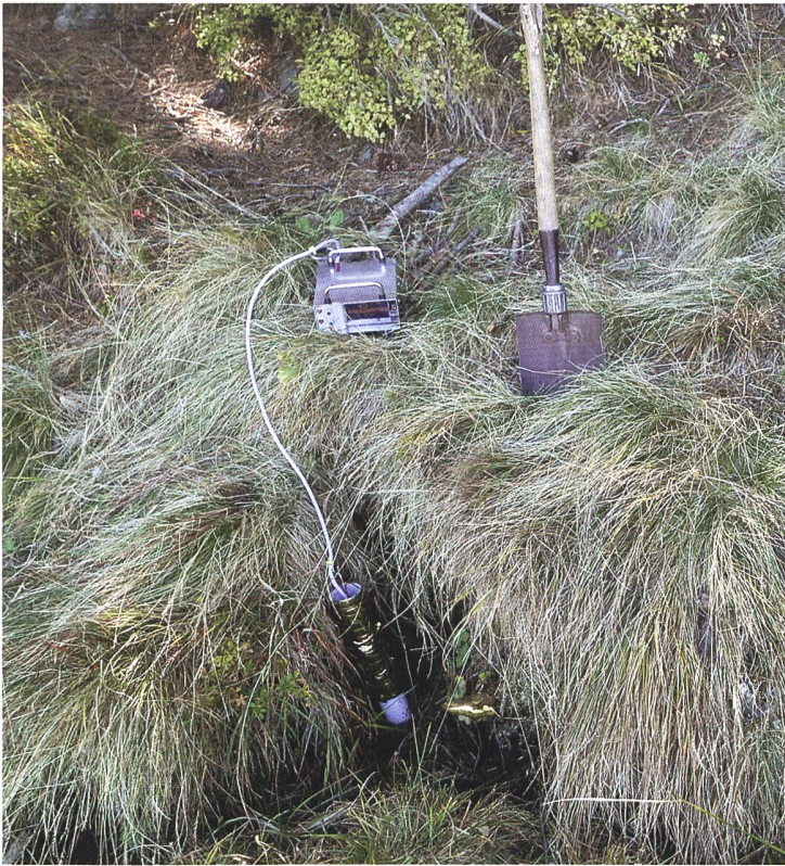
Abb. 12: Entnahmestelle der Bodenprobe TA12-71, siehe Abb. 3. Die Stelle befindet sich am Westrand des Flachmoors C am Hangfuss bei einer Austrittsstelle von Wasser. Die Zählrate im Graben beträgt 3.5 kcps, gemessen mit der NaI-Zähler-Eigenentwicklung HAL2022 des Autors (STUCKI 2023a).
