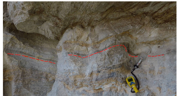
Abb. 18: Detail der Stelle TA5-5. Die Indikationen liegen im dunklen Band oberhalb der roten gestrichelten Linie. Der höchste Messwert liegt bei (15.5 \pm 0.1) kcps. Rechts unten ist der SEA Szintillationszähler mit der Graetz-2002-Sonde zu sehen. In den bräunlichen Bändern kommen gemäss FELDMANN (1986) Karbonate vor, die als Ankerit auftreten.
