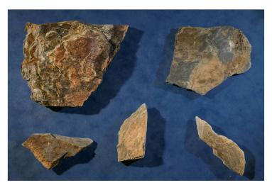
Abb. 25: Erzproben der Stellen TA12-22 (links oben), TA12-6 (rechts oben) und TA11-9 (die drei Stücke unten). Die Messwerte mit dem GM-Zähler direkt auf den Schiefern betragen 0.13 mSv/h bis 0.25 mSv/h, die Urangehalte 0.7 bis 1.9 Gewichtsprozente. Die Zählraten an den Fundstellen TA12-22 und TA11-9 ergaben über 150 kcps für den Szintillationszähler. Bildbreite 25 cm.
