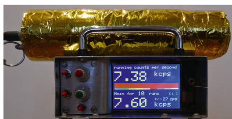
Abb. 5: Vorderansicht der NaI-Szintillationszähler-Eigenentwicklung HAL-2022. Quer darauf liegt ein Rohr, welches den NaI-Kristall und den sogenannten Photomultiplier enthält. Die goldfarbene Folie soll zu rasche Temperaturänderungen im Freien verhindern, zusätzlich ist das Rohr durch eine Schaumstoffumhüllung vor (im Feld unvermeidlichen) Schlägen und Erschütterungen geschützt.
