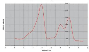
Abb. 20: Dass die Anomalienzone schmal ist, zeigt das Gamma-Log der Stelle TA11-6 (Koordinaten 631478 / 123197) senkrecht zur Indikationenzone. Alle 0.5 Meter wurde direkt auf der Bodenoberfläche (Moräne/Vegetation) gemessen. Ein kleiner, 15 cm tiefer Schürfgraben zeigte einen nicht anstehenden Block, auf dem eine Rate von (34.7 +/- 0.1) kcps gemessen wurde.
