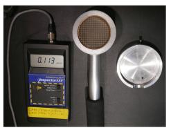
Abb. 6: Der Geiger-Müller-Zähler «Inspector» mit externem Pancake-Zählrohr (Mitte) zeigt aktuell eine Aequivalenzdosisleistung von 0.113 Mikrosievert/Stunde an. Das Zählrohr verfügt über ein Fenster mit einer 8 Mikrometer dünnen Mica-Folie, welche durchlässig für Alphastrahlung ist. Gegen mechanische Beschädigung ist sie mit einem Gitterchen geschützt. Wenn man das Fenster mit dem Aludeckel (rechts) abdeckt, wird nur noch Gammastrahlung gemessen.
