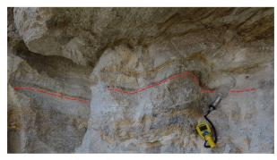
Abb. 18: Detail der Stelle TA5-5. Die Indikationen liegen im dunklen Band oberhalb der roten gestrichelten Linie. Der höchste Messwert liegt bei (15.5 +/- 0.1) kcps. Rechts unten ist der SEA Szintillationszähler mit der Graetz-2002-Sonde zu sehen. In den bräunlichen Bändern kommen gemäss FELDMANN (1986) Karbonate vor, die als Ankerit auftreten.
