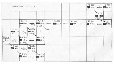
Abb. 4: Die «Natürliche radioaktive Familie» von U-238 [Nuklidkarte, 5. Auflage, Seelmann-Eggebert et al. (1981)] zeigt übersichtlich die möglichen Zerfallskanäle des Urankerns. Am Schluss landen alle beim Blei-Isotop Pb-206.
