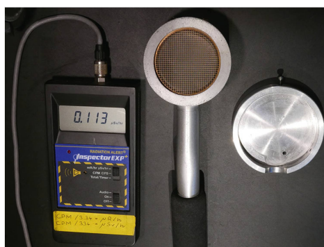
Abb. 6: Der Geiger-Müller-Zähler «Inspector» mit externem Pancake-Zählrohr (Mitte) zeigt aktuell eine Äquivalenzdosisleistung von 0.113 Mikrosievert/Stunde an. Das Zählrohr verfügt über ein Fenster mit einer 8 Mikrometer dünnen Mica-Folie, welche durchlässig für Alphastrahlung ist. Gegen mechanische Beschädigung ist sie mit einem Gitterchen geschützt. Wenn man das Fenster mit dem Aludeckel (rechts) abdeckt, wird nur noch Gammastrahlung gemessen.
