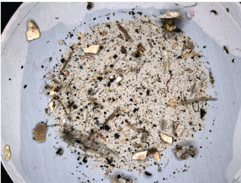
Abb. 2: Filter mit aus dem Boden extrahierten Mikroplastik. Die schwarzen Partikel stellen Reifenabrieb dar, die weissen und transparenten Partikel Bruchstücke von Verpackungsmaterial. Ausserdem sind deutlich rote Plastikfasern zu sehen. Neben Mikroplastik sind auf dem Filter auch noch Reste organischen Materials (Holz usw.). Das Mikroplastik in der Abbildung ist aus 5 g Boden extrahiert.
