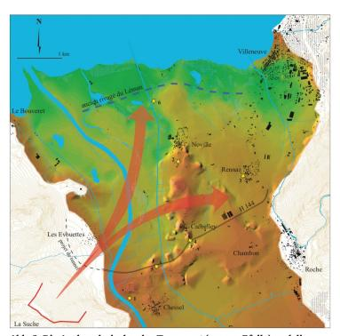
Abb. 3: Die Ausbruchnische, der Transport (orange Pfeile) und die hügeligen Ablagerungen (braun bis orange dargestellt) des «Suche»-Bergsturzes zwischen Le Bouveret, Villeneuve, Chessel und Vouvry (liegt links unten; gerade ausserhalb des Kartenausschnitts).
