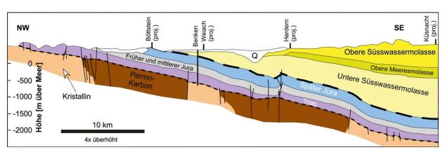
Abb. 1: Geologisches Profil durch die zentrale Nordschweiz. Profilspur: Randen (SH)–Winterthur–Hörnli (ZH). Der Opalinuston befindet sich innerhalb der grauen Schicht (Früher und mittlerer Jura).
