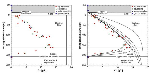
Abb. 6: Cl<sup>-</sup>-Gehalte im Porenwasser des Opalinustons im Felslabor Mont Terri. Nach Mazurek et al. (2011). Zahlen bei den modellierten Kurven markieren die Zeitdauer seit Aktivierung des oberen Aquifers in Millionen Jahren.
