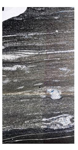
birges entstanden ist. Diese Struktur wurde in unmittelbarer Nähe des illustrierten Aufschlusses mehrfach durchbohrt und hydraulisch betestet. Die Wasserdurchlässigkeit der Bruchzone war nicht von derjenigen des undeformierten Opalinustons unterscheidbar, also extrem tief – dies trotz des hohen Deformationsgrads.
