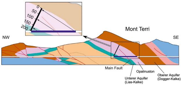
Abb. 5: Geologisches Profil durch die Mont Terri-Antiklinale. Die Position des Felslabors ist blau markiert.
