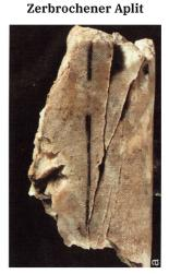
Abb. 2: Beispiele von Bruchstrukturen in Bohrkernen des Kristallins der Nordschweiz.
