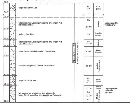
Abb. 6: Die Bohrprofile der benachbarten Sondierbohrung RB 9/P (Stauweiher BKW Spiezmoos) und der meisselnden Spülbohrung zur Erdsonde des EFH Walter (Umbau BE 1272 Spiezberg West) entsprechend dargestellt).
