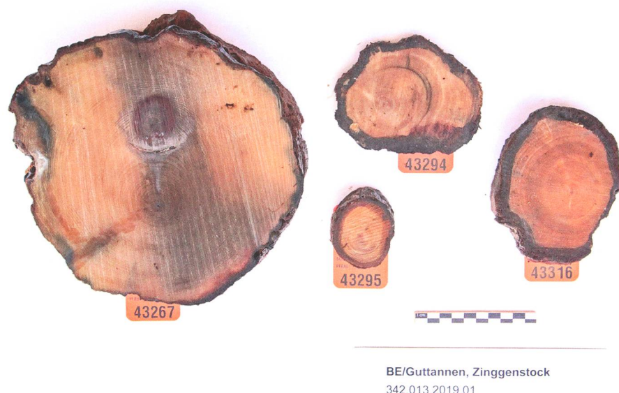
Abb. 23: Die vier für die dendrochronologische Untersuchung vorliegenden Balkenscheiben. Gut erkennbar ist der perfekt erhaltene und noch immer wohlriechende Kern der Arvenhölzer. Die Zellen in den dunklen Bereichen sind bereits stark abgebaut, jedoch in ihrer Grundstruktur noch erhalten und messbar.
