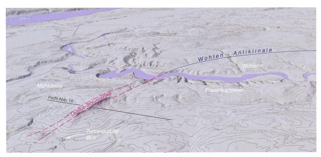
Abb. 11: Lediflue bei Rosshäusern, Gemeinde Mühleberg. Das Geländemodell in Vogelschauperspektive zeigt die Verbiegung der Achse der Wohlen-Antiklinale, woraus der Scheitelbruch an der Lediflue hervorgeht. (Abbildungsgrundlage Bundesamt für Landestopographie swisstopo).
