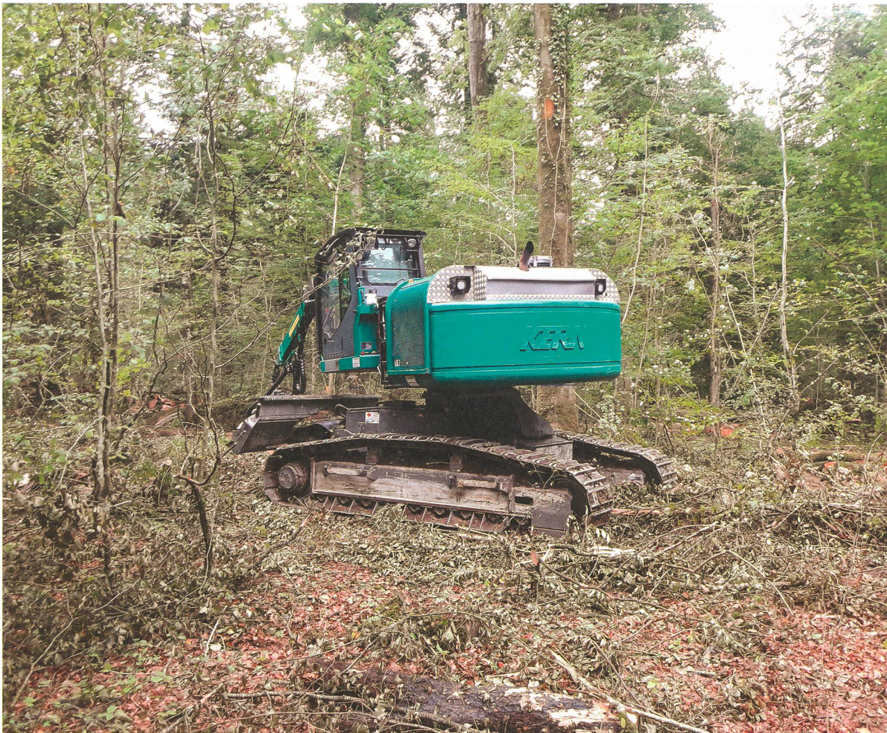
Gegen Bodenverdichtung setzt der Forstbetrieb einen Harvester mit Raupenantrieb ein, welcher die Last auf eine grössere Fläche verteilt als herkömmliche, radbetriebende Modelle.
