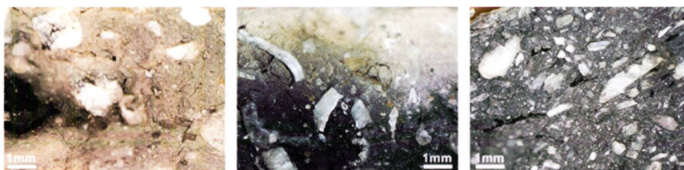
Abb. 9: Makrofotos der Bruchflächen von Keramik Sutz-Lattrigen. Links: silikatischer Ton mit Gesteinsbruchstücken. Mitte: fossilienhaltiger Mergel mit Gesteinsbruchstücken. Rechts: silikatisch-karbonatischer Ton mit Kalzitbruchstücken.
