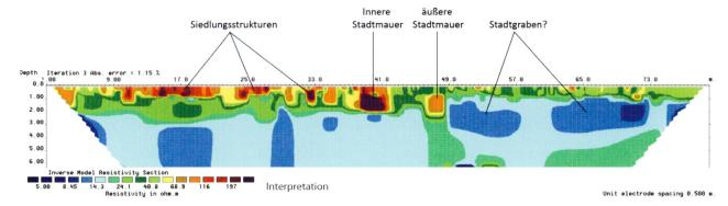
Abb. 7: Geoelektrische Tomografie (Profil) durch das Befestigungssystem und die anschliessende Wohnbebauung der südöstlichen Unterstadt.
