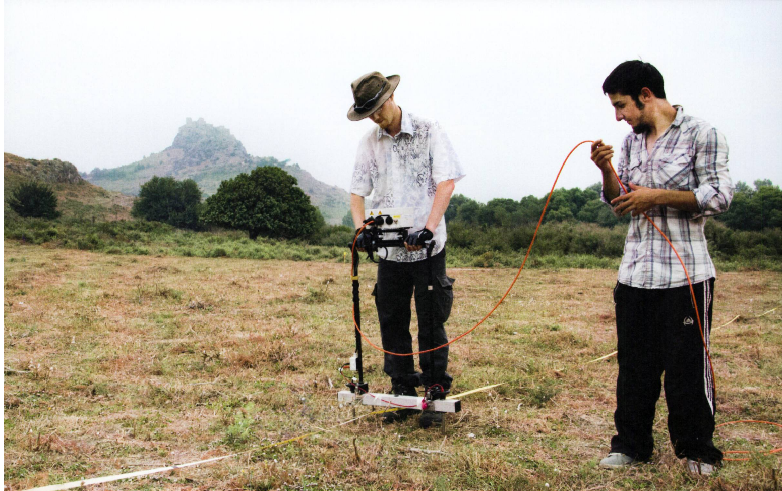
Abb. 6: Zwei Studierende bei der Durchführung einer geoelektrischen Tomografie; im Hintergrund ist die mittelalterliche Burg Yılan Kalesi zu sehen.
