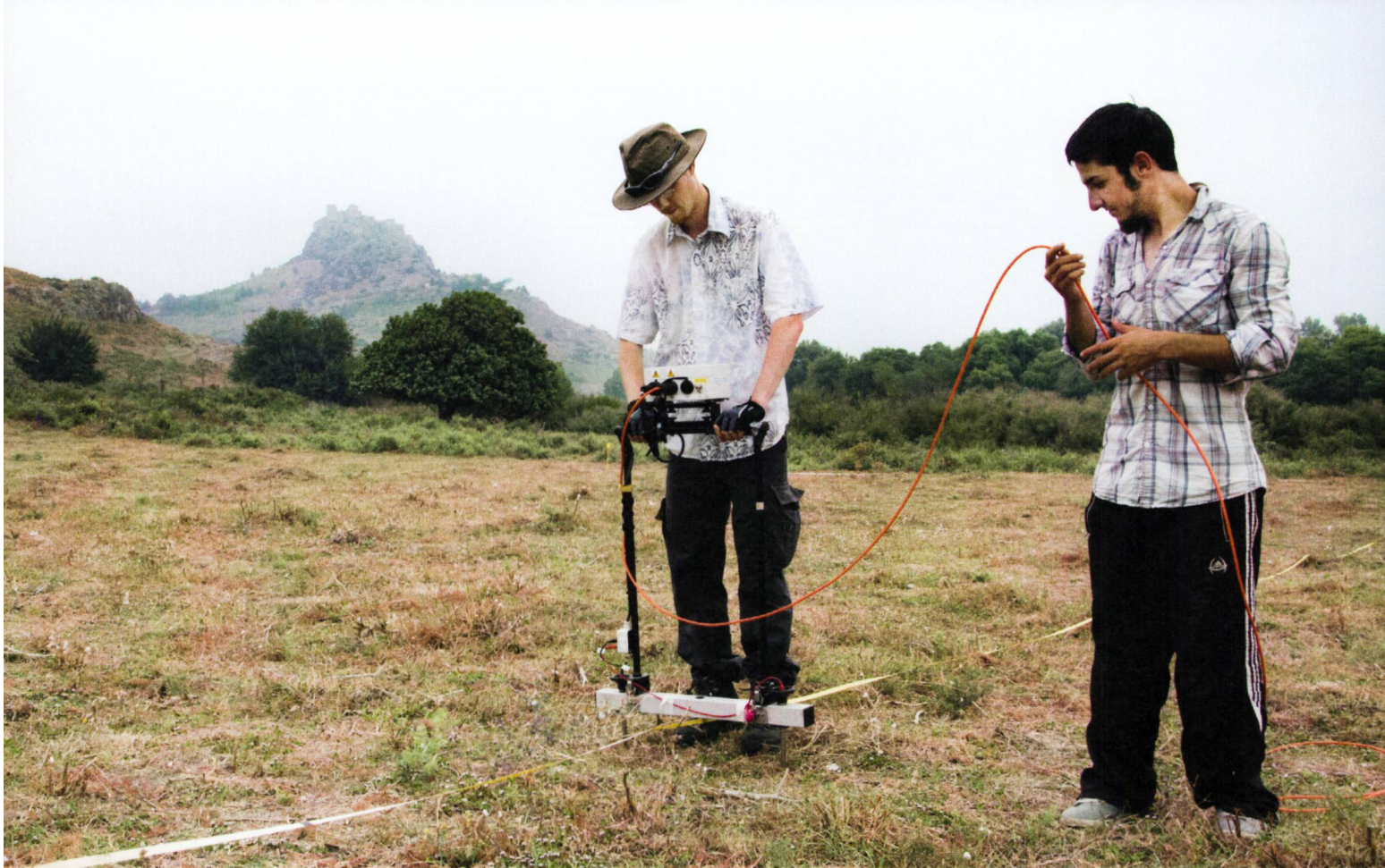
Abb. 6: Zwei Studierende bei der Durchführung einer geoelektrischen Tomografie; im Hintergrund ist die mittelalterliche Burg Yilan Kalesi zu sehen.
