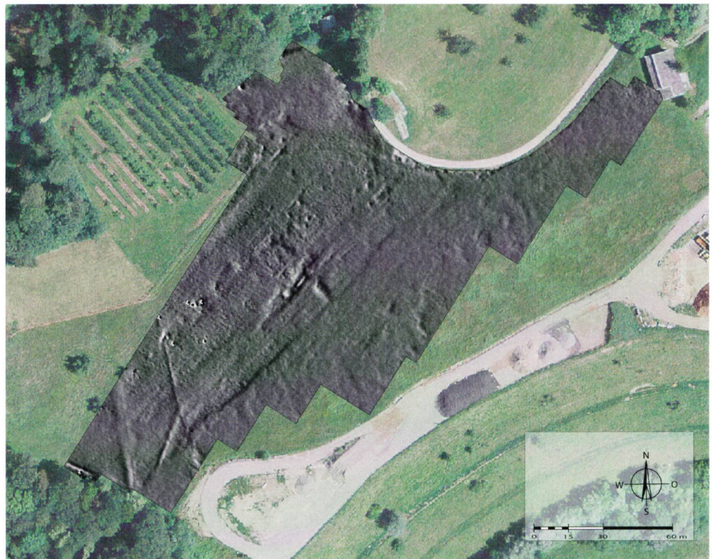
Abb. 6: Studen-Petinesca, Ergebnisse der geoelektrischen Prospektion: Relief-Darstellung über Orthofoto. Mittels Variation von Richtung und Einfallswinkel verändert sich der von erfassten Befunden gebildete Schattenwurf, wodurch gewisse Details nuanciert werden können. (Bildnachweis: Flugaufnahme Bundesamt für Landestopografie/swisstopo, Plangrundlage: grafische Bearbeitung M. Buess)
