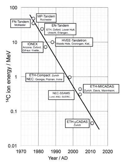
Abb. 4: Technische Entwicklung der <sup>14</sup>C-Messung mit AMS über die letzten 40 Jahre (Synal, 2013). Die notwendige Energie der beschleunigten <sup>14</sup>C-Ionen (engl.: <sup>14</sup>C ion energy) bestimmt massgeblich die Grösse und die Komplexität einer AMS-Anlage. Die einzelnen Schritte dieser Entwicklung sind jeweils durch den verwendeten Beschleunigertyp oder den Gerätenamen gekennzeichnet zusammen mit einigen Institutionen oder Standorten mit einer solchen Anlage.
