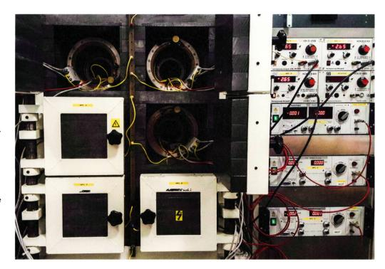
Abb. 2: Die von Hans Oeschger entwickelten Gasproportionalzählrohre in der Klima- und Umweltphysik der Universität Bern. Blick auf die Zählrohre (links oben), verschlossene Bleikammern bereit zur Messung (links unten) und Messelektronik (rechts) (Foto: Th. Wagner).
