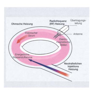
Abb. 5: Die verschiedenen Arten von Heizungssystemen für das Plasma: Ohmsche Heizung, Heizung mithilfe von elektromagnetischen Wellen (Mikrowellenheizung) und Neutralteilcheninjektion.
