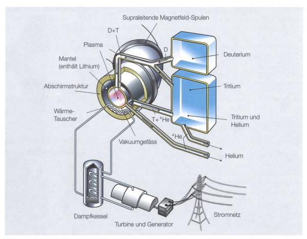
Abb. 3: Funktionsschema eines Fusionsreaktors.
