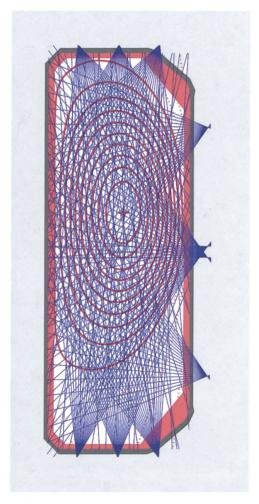
Abb. 7: Verteilung der zehn tomografischen Kameras, jeweils mit 20 Kanälen, die um die Vakuum-Kammer des TCV platziert sind.
