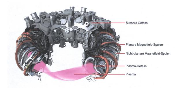
Abb. 12: Schematische Ansicht des supraleitenden Stellarator Wendelstein 7-X.
