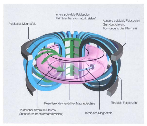
Abb. 4: Schema des Tokamak-Konzeptes.
