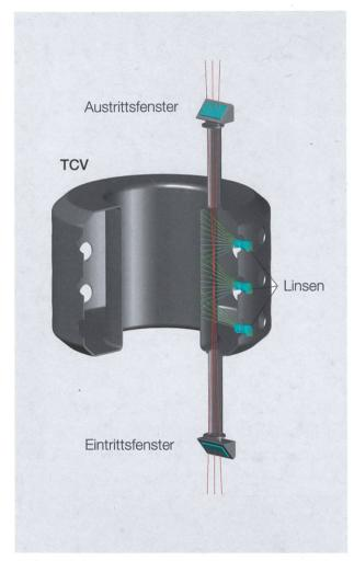
Abb. 8: Schema der Anlage zur Messung von Thomson-Streuung, welche zur Bestimmung der Plasmatemperatur dient.
