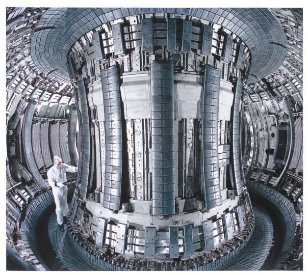
Abb. 11: Innenansicht der Vakuum-Kammer des JET Tokamak.
