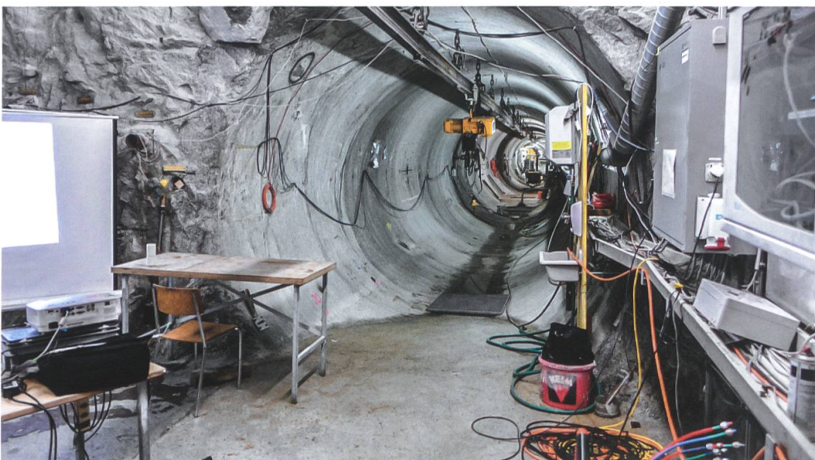
Abb. 6: Experiment zum stimulierten Aufbrechen des Kristallingesteins.
