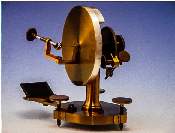
Abb. 19a,b: Optische Reflexionsgoniometer. Abb. 19a: Links – Wollaston-Typ Reflexionsgoniometer der Firma Dubosc (Paris, Mitte 19. Jahrhundert) mit horizontaler Drehachse. Der Kristall wird auf die mit K gekennzeichnete Halterung justiert und durch Drehen der Mess-Spindel wird ein Lichtstrahl von einer externen Quelle auf der Kristallfläche zur Reflexion gebracht und der Reflexionswinkel notiert. Abb. 19b: Rechts – Goldschmidt-Typ Zweikreisgoniometer mit integrierter Lichtquelle und Beobachtungsfernrohr. (Fotos: Olaf Medenbach)
