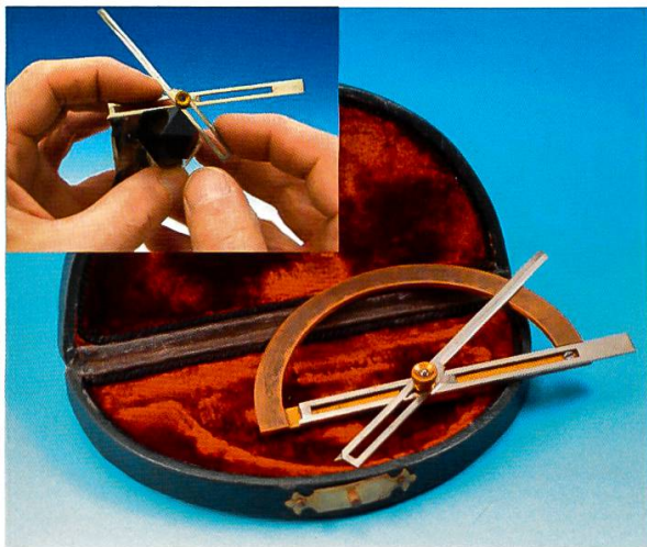
Abb. 18: Carangeot-Typ Anlegegoniometer zur Vermessung von Kristallflächen der Firma Stoe um 1900. (Foto Olaf Medenbach)
