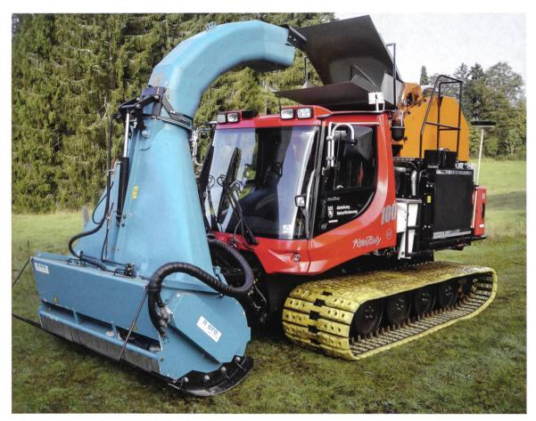
Abbildung 23: Die neue Schilfmähmaschine der ANF mit Mähwerk und Rundballenpresse. (Foto: Thomas Leu)
