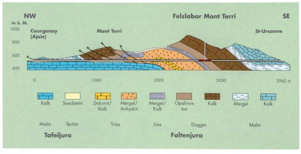
Abbildung 4: Geologisches Profil entlang dem 4 km langen Autobahntunnel Mont Terri (Grafik swisstopo, 2012).
