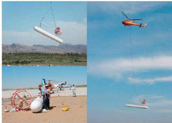
Abbildung 6: Geomagnetische Messungen der Bundesanstalt für Geowissenschaften und Rohstoffe (BGR) aus Hannover, Deutschland, in der chinesischen Kohlebrandregion Wuda. Fotos: BGR
