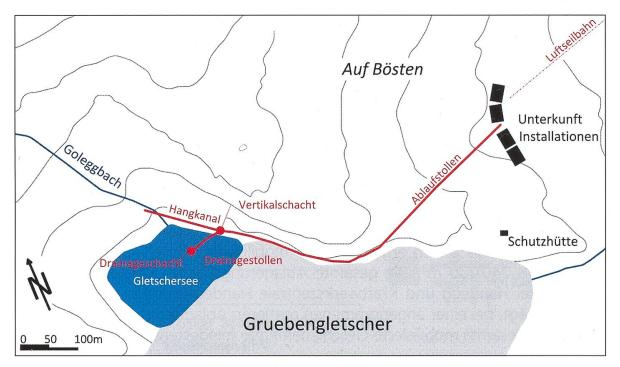
Abbildung 16: Schematische Darstellung der ausgeführten Hauptbestandteile der Gletschersee-Trockenlegung.
