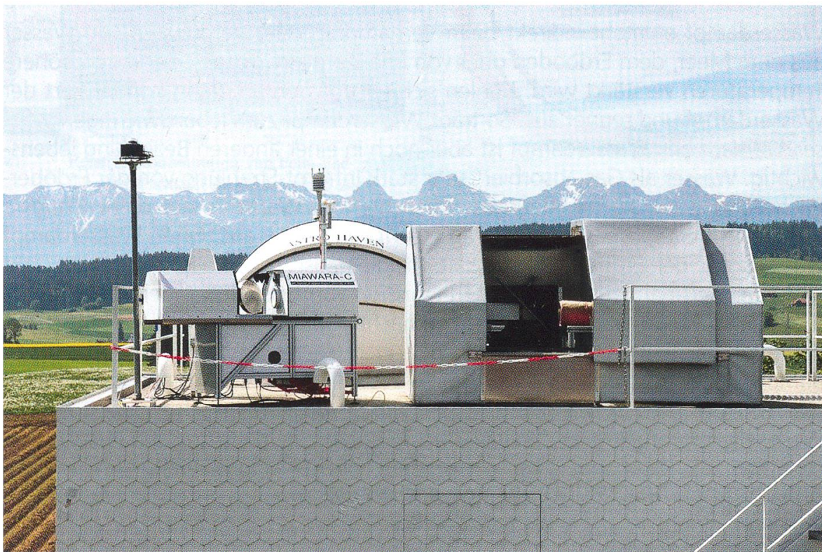
Observatorium Zimmerwald mit Mikrowellen-Radiometern zur Bestimmung von atmosphärischem Wasserdampf vom Boden bis auf rund 80 km Höhe. Bild von M. Canavero, IAP.
