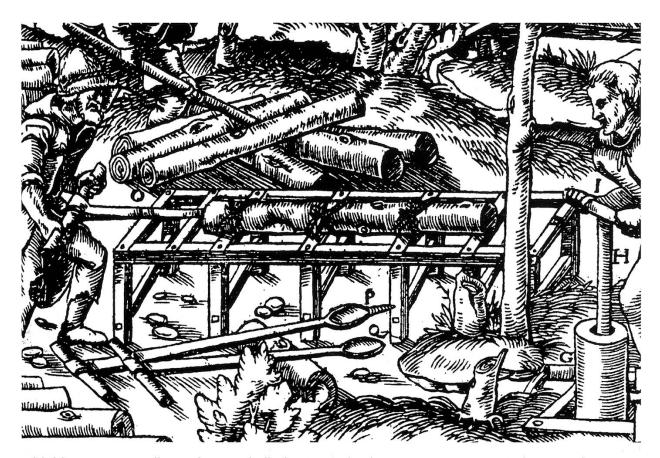
Abbildung 6: Darstellung des Teuchelbohrens. Holzschnitt aus Georg Agricola 1556 (BAERISWYL/GERBER, Ratsherren, 57)<sup>6</sup>.
