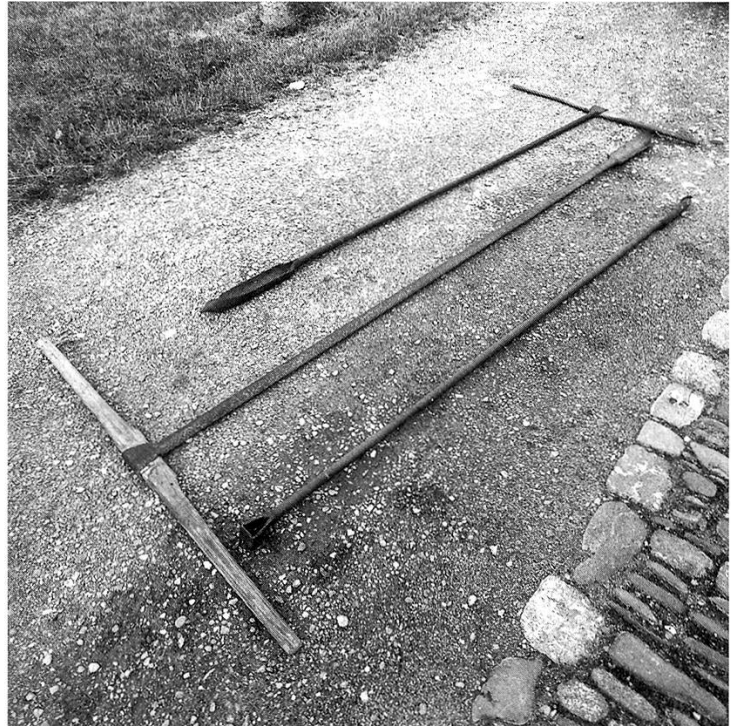
Abbildung 7: Teuchelbohrer, wie sie noch im 19. Jahrhundert im ländlichen Raum nahe Bern verwendet wurden (BAERISWYL/GERBER, Ratsherren, 57) 6 .
