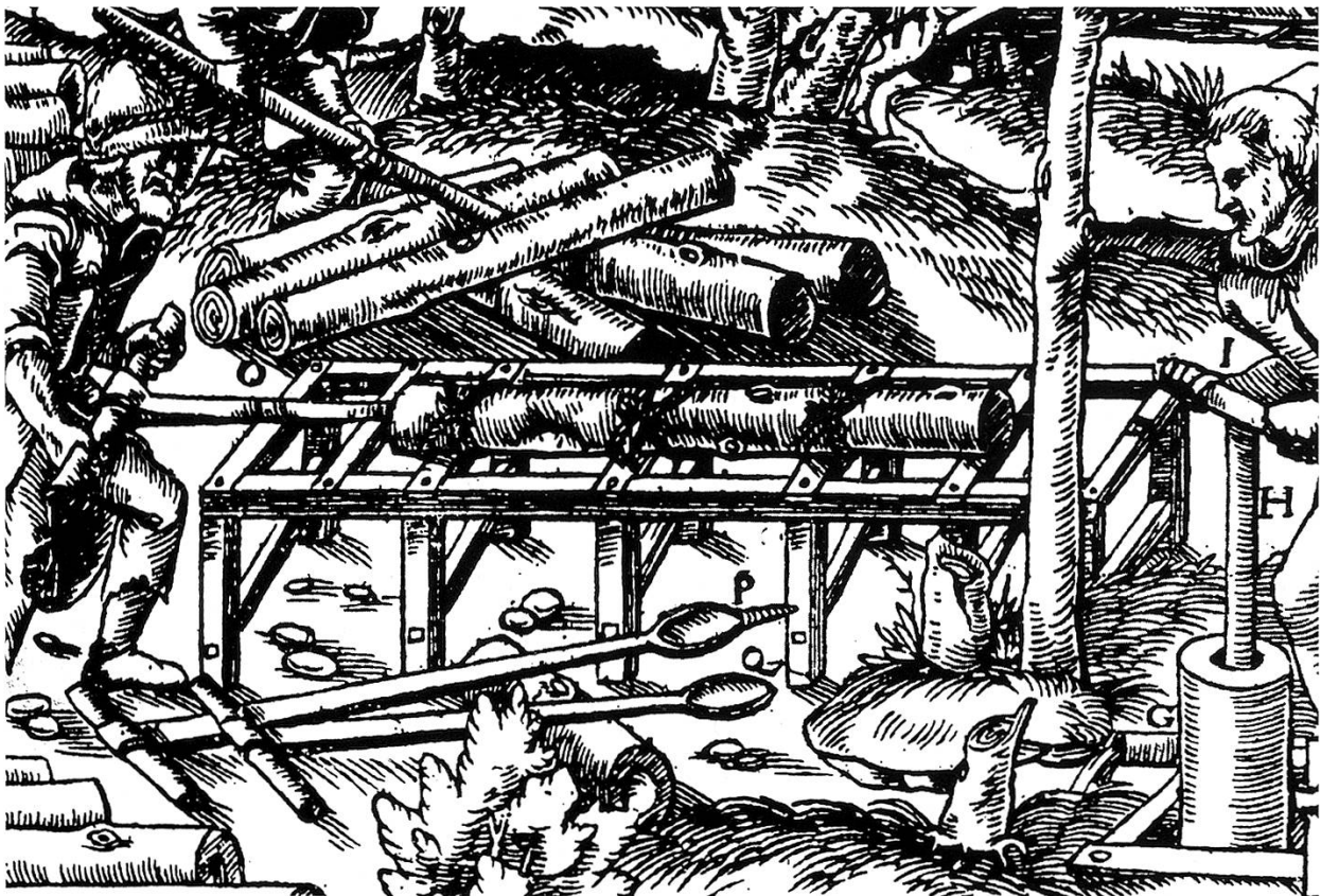
Abbildung 6: Darstellung des Teuchelbohrens. Holzschnitt aus Georg Agricola 1556 (BAERISWYL GERBER, Ratsherren, 57) 6 .
