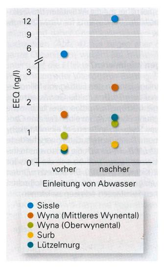
Abbildung 2: Durchschnittliche Konzentration von östrogen aktiven Stoffen (EEQ = Östradiol-Äguivalente) in den Schweizer Flüssen Sissle, Surb, Lützelmurg und Wyna vor und nach der Einleitung von gereinigtem Abwasser aus Kläranlagen. Die Studie erfolgte 2004, mittlerweile wurde die Einleitung von Abwasser in die Sissle massiv reduziert. Nach Vermeirssen et al. 2005, Grafik: Eawag
