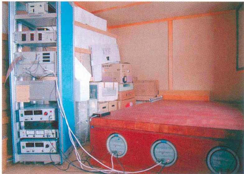
Abbildung 9: 3-NM-64 mit Messelektronik in der Messhütte auf dem Dach der Forschungsstation Jungfrauoch.
