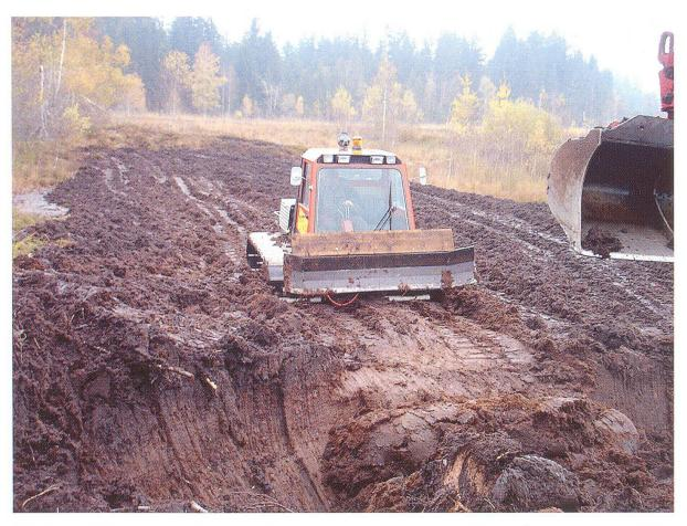
Abbildung 7: Zusammenschieben des Torfes mit einer umgebauten kleinen Pistenmaschine. (Foto: Naturschutzinspektorat, November 2007)
