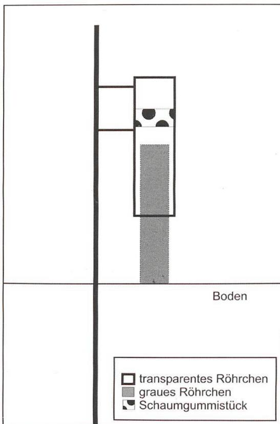
Abbildung 1: Frosthubapparat.
