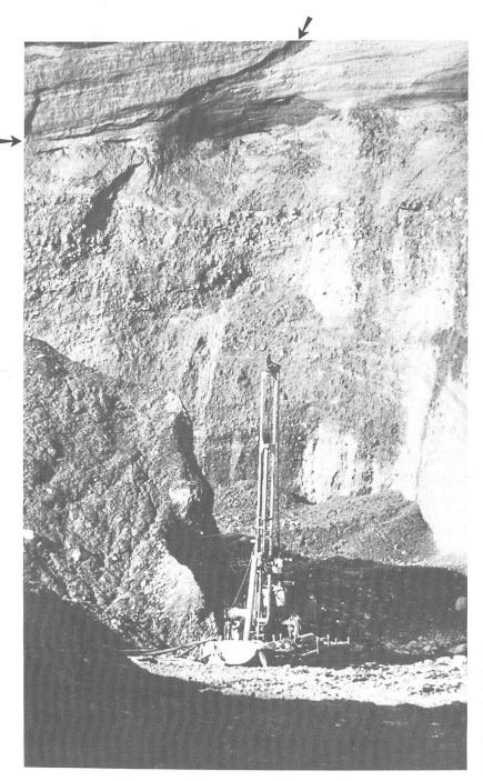
Abbildung 21: Aufnahme des südlichen Kiesgrubenareals mit Bohrturm der ersten Forschungsbohrung. In der Kiesgrubenwand ist die markante Schichtlücke im oberen Profilteil ersichtlich (Pfeile).
