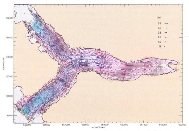
Abbildung 14: Fotogrammetrische Bewegungsmessungen 1997/98 an der Oberfläche des Unteraargletschers (nach Bauder 2001: 65).
