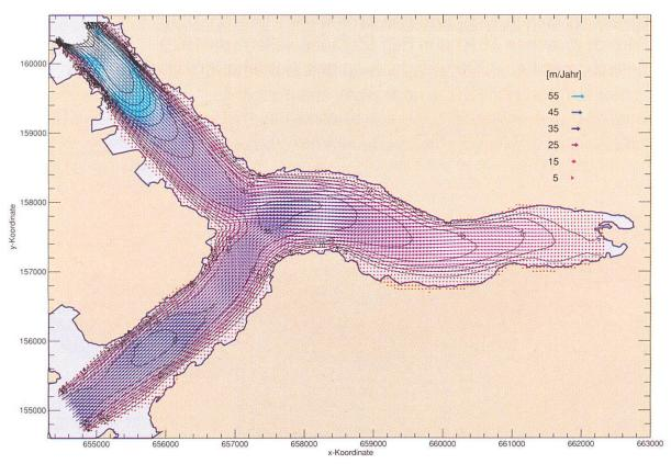
Abbildung 15: Modellierte Geschwindigkeit 1997/98 an der Oberfläche des Unteraargletschers (nach BAUDER 2001: 93).
