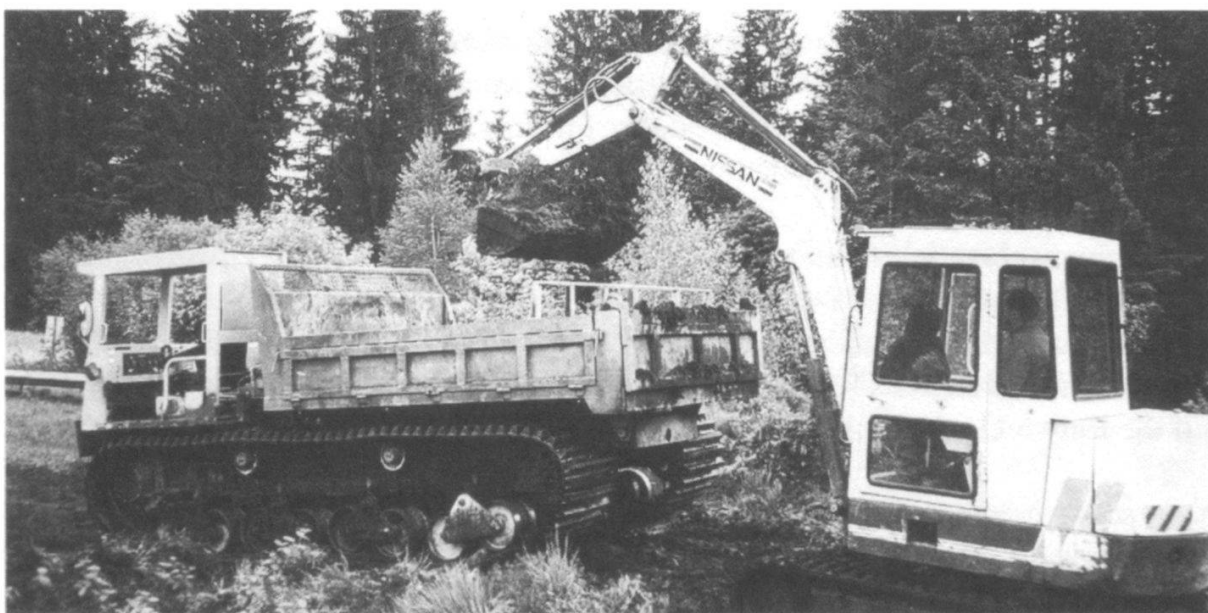
Abbildung 2: Torftransport mit Mariokka-Dumper. Mit 3 m 3 Torf geladen total 220 g/cm 2 Bodendruck; gegenüber Person mit 88 kg und Schuhnummer 46: 170 g/cm 2 . (Foto R. Keller, Mai 1998)
