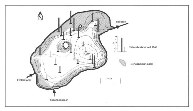
Abbildung 7: Mit dem Kartenvergleich ermittelte Auflandung des Inkwilersees seit 1949. Die dunklen Balken zeigen eine Tiefenabnahme von mehr als einem Meter, die hellen entsprechend von weniger als einem Meter.
