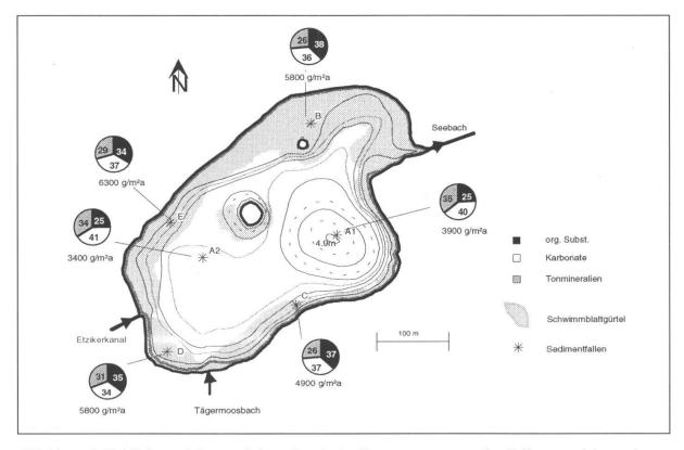
Abbildung 5: Zeitlich gewichtete mittlere chemische Zusammensetzung des Fallenmaterials sowie gemessene Jahressedimentation im Untersuchungszeitraum 1995/96 im Inkwilersee.
