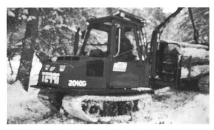
Abbildung 8: Kleinfahrzeug Terri 2020 D, welches sich im praktischen Test gut geeignet hat, mit Raupen, Hebekran und mit 3 m<sup>3</sup> Holz beladenem Raupenanhänger. (Foto R. Keller, November 1996)
