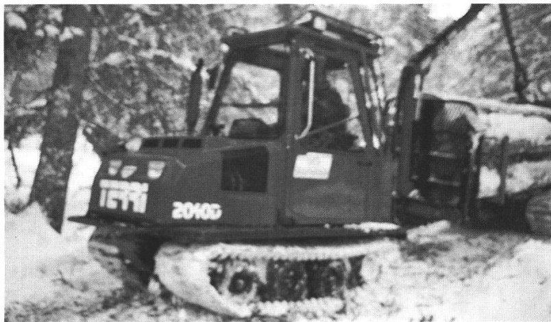
Abbildung 8: Kleinfahrzeug Terri 2020 D, welches sich im praktischen Test gut geeignet hat, mit Raupen, Hebekran und mit 3 m 3 Holz beladenem Raupenanhänger. (Foto R. Keller, November 1996)
