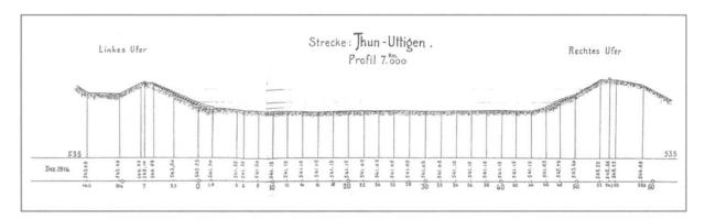
Darstellung 2: Querprofil des Aare-Kanals bei Uttigen, aus Schweiz. Oberbauinspektorat 1916.
