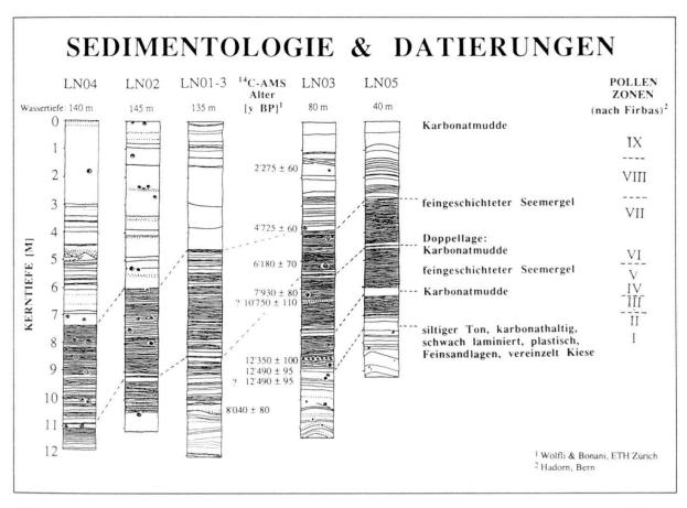
Abbildung 6: Sedimentologie, AMS-Datierungen und Pollenanalyse der Sedimentkerne aus dem Neuenburgersee (Schwalb 1992).
