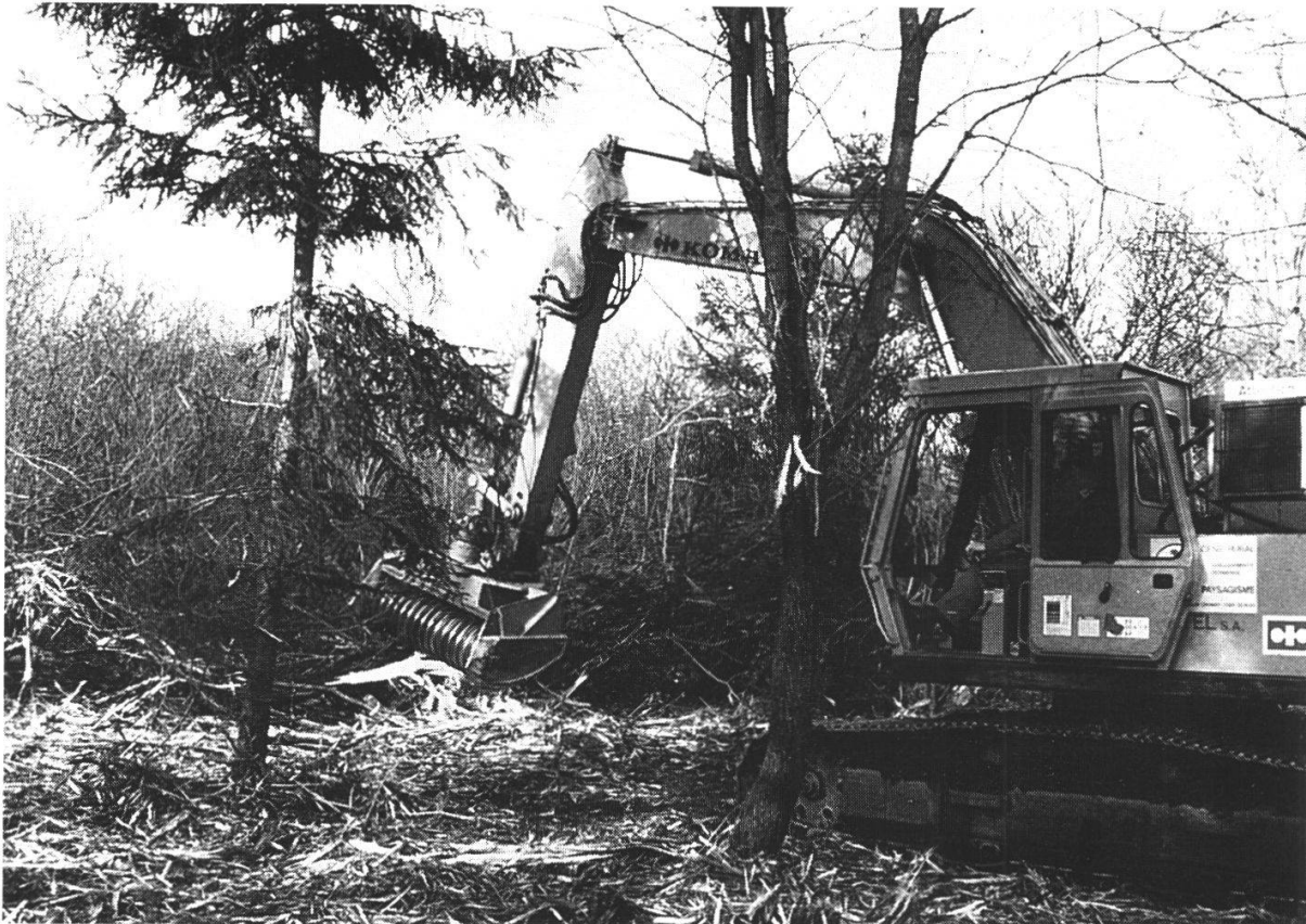
Abbildung 3: «Broyeur» der Firma ELTEL (Komatsu-Bagger mit Schlegelkopf) beim Entbuschen in der Kleinhöchstettenau. (Foto H. Kasper, 1. Februar 1990)
